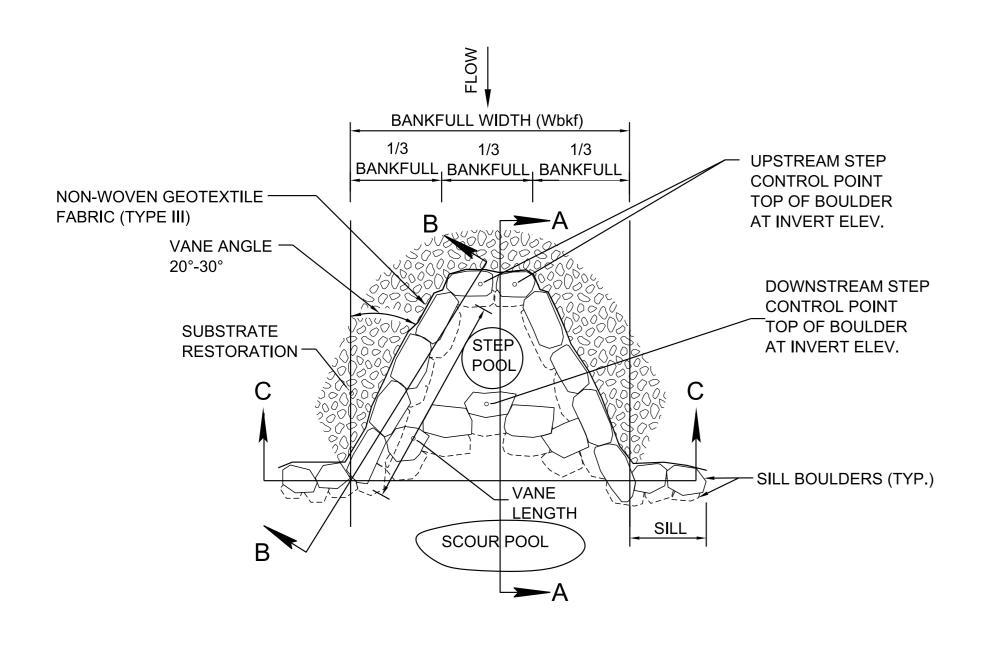
NON-WOVEN GEOTEXTILE — FABRIC (TYPE III) **SCOUR POOL** POOL SURFACE **BOULDER FOOTER BOULDER** STREAMBED ELEV. -FOOTER NON-WOVEN GEOTEXTILE -**BOULDER** FABRIC (TYPE III)
