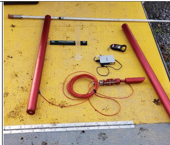
معدات اختبار التعبئة الناقصة (جزء السوائل من الخزان) Alert 8200 تتكون من مجسات طفو كتلة وخليية تحميل.
