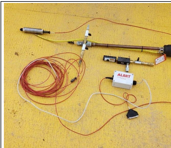
معدات اختبار الفراغ القمي (الجزء الفارغ من الخزان) Alert 8200 تتكون من سداة تمدد ومولد ضغط/خواء ومسبار.
