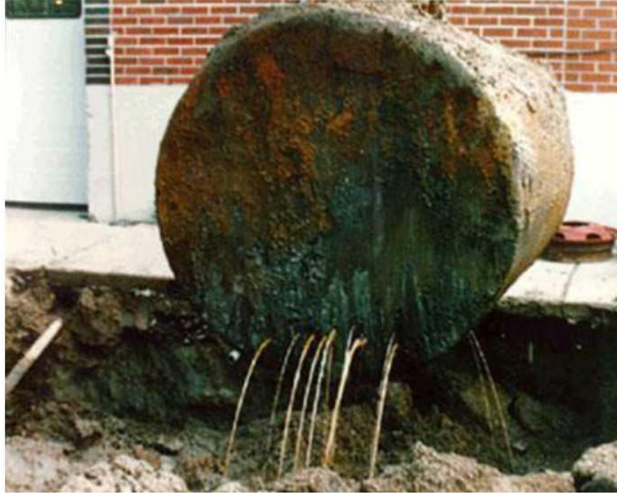
بدون الحماية المناسبة من التآكل، قد يتسرب المنتج.
