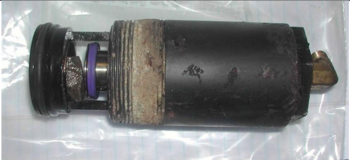
Đá được chèn vào để vô hiệu hóa thiết bị phát hiện rò rỉ đường ống
